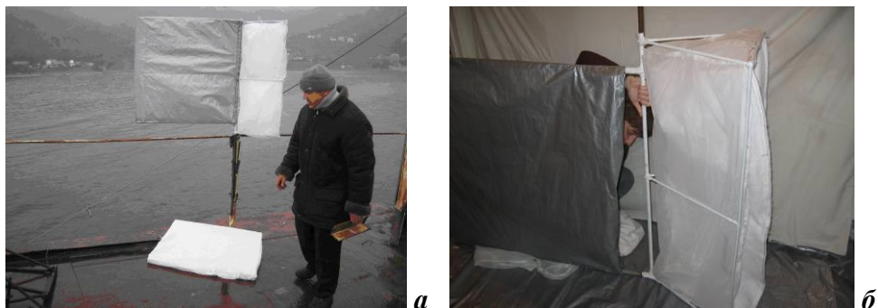
Р и с . 1 . Процес підготовки до експлуатації пасток з відбору горизонтальних та вертикальних потоків еолової речовини на Океанографічній платформі (а); збір конструкції пастки – закріплення армованого стабілізатора напрямку до основного каркасу (б).
