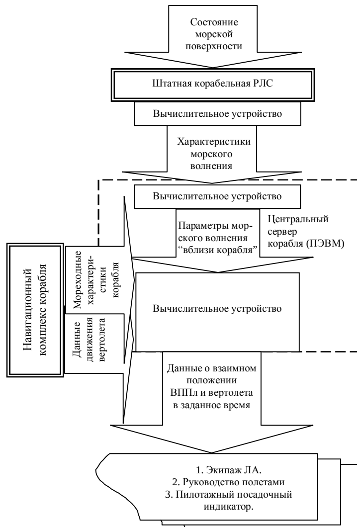
Р и с . 1 . Принципиальная схема функционирования усовершенствованной СОВП вертолета.
