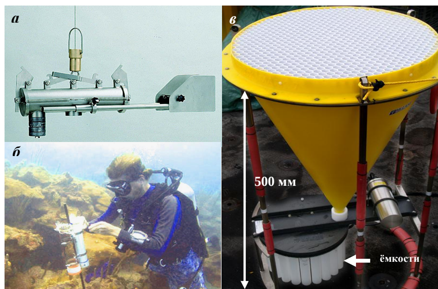
Р и с . 1 . Виды пробоотборников: ручной подвесной пробоотборник (батометр) (а); донный пробоотборник, обслуживаемый водолазом (б); ловушка взвеси с последовательным отбором проб в отдельные герметичные ёмкости (в).
