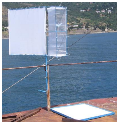
Рис. 2. Пастки для атмосферного аерозолію горизонтального та вертикального потоків.
