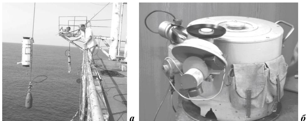
Р и с . 3 . Фрагмент рабочей палубы платформы. На переднем плане – батометр для отбора проб, в руках оператора – измеритель стратификации прозрачности и температуры, на мостке установлен фотометр «Спектр» для измерений коэффициента спектральной яркости моря (а); внешний вид спектрофотометра «Спектр» для дистанционных измерений коэффициента яркости моря (б).
