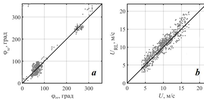
Рис. 8. Направление (а) и модуль скорости ветра (б), полученные по данным анемометра и РЛ измерениям. Прямая линия соответствует равным значениям двух величин
