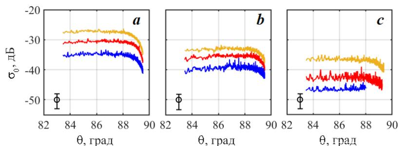
Р и с . 4. УЭПР морской поверхности как функция угла наблюдения при измерениях «на ветер» (a), «перпендикулярно ветру» (b) и «по ветру» (c). Синяя линия – данные, усредненные в диапазоне  $U = 7.0 \pm 1.5$  м/с; красная –  $11.0 \pm 1.5$  м/с; оранжевая –  $15.0 \pm 1.5$  м/с. Доверительные интервалы приведены в левой нижней части рисунка
