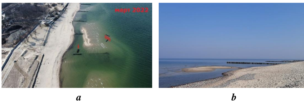
Рис. 12. обнажение вершины подводного вдольберегового вала в марте 2022 г. накануне его причленения к урезу при экстремально низком уровне моря: a – береговой сегмент, где был установлен волнолом (красные стрелки); b – сегмент берега на расстоянии 400 м к западу от точки установки волнолома
