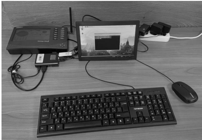
Р и с . 1 . Внешний вид рабочего места проведения измерений в автоматическом режиме, а также передачи и хранения данных метеостанции Davis Vantage Pro 2 с использованием АПК Raspberry Pi B+
