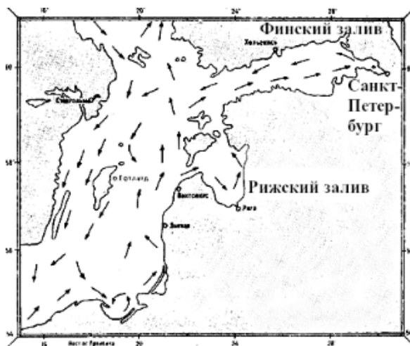
Рис. 2. Схема основных постоянных течений в Финском заливе. Стрелками показано направление течений
