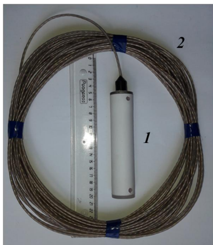
Р и с . 1 . Автономный измеритель внутренних волн: 1 – записывающее устройство; 2 – РДТ длиной 20 м
