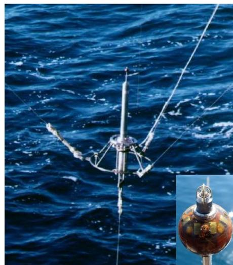
Рис. 1. Позиционный вариант комплекса «Сигма-1» и блок датчиков
