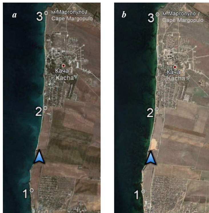
Рис. 1. Космические снимки района у пос. Кача: a – 2004 г., b – 2019 г. Стрелкой показана Немецкая балка. Цифрами обозначены места наблюдений за положением кромки клифа
