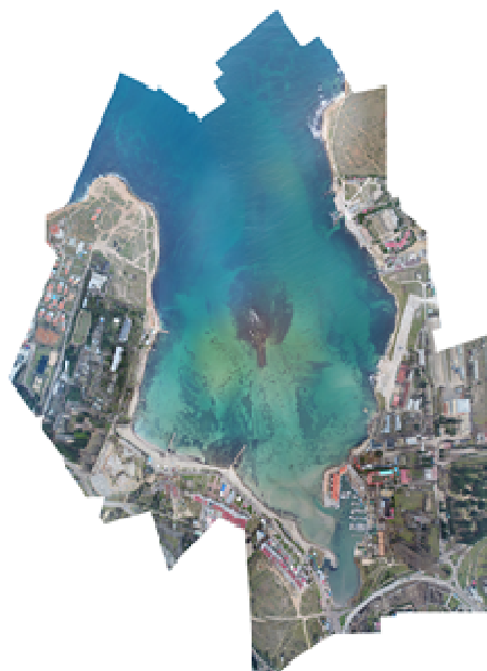
Р и с . 1 . Ортофотоплан бухты Круглая, выполненный по аэрофотоснимкам, полученным с помощью БПЛА.
