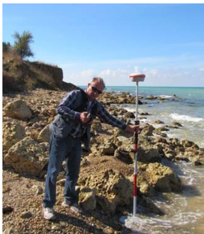
Р и с . 3 . Измерения в режиме RTK положения линии уреза воды в южной части пляжа «Учкуевка» (а) и границы верхней кромки клифа на м.Маргопуло (б).
