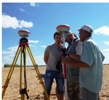
Р и с . 1 . Установка базовой станции и инициализация комплекта GNSS -приемников EFT M1 для работы в режиме « Stop-And-Go » на пересыпи оз.Богайлы.
