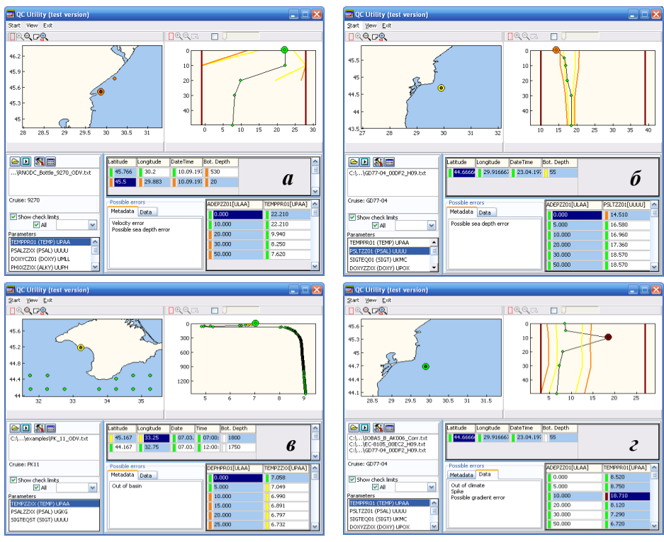
Р и с 3. Проведение процедуры контроля качества. Примеры отображения ошибок метаданных и данных: ошибка скорости судна (а), ошибка глубины места (б), ошибка местоположения станции (в), ошибка данных – спайк (г).
