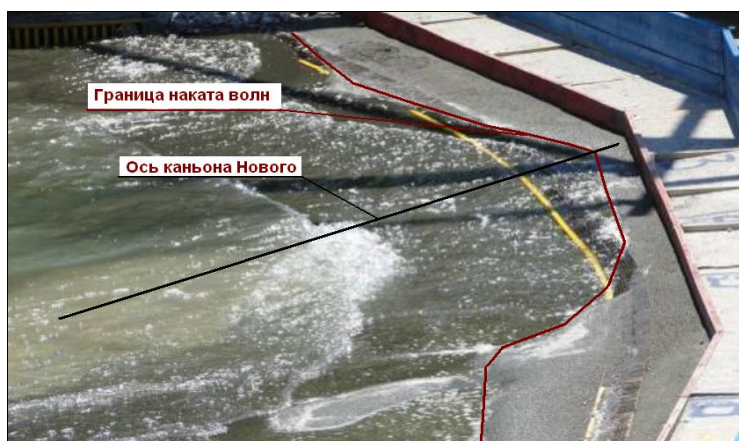
Р и с . 4 . Накат волн на пляж и сооружение в районе каньона Нового в опыте на гидравлической модели в волновом бассейне.
