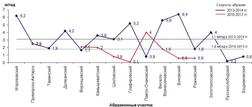
Р и с . 3 . Скорость абразии на аварийных участках Азовского моря за 2013 – 2014 гг.
